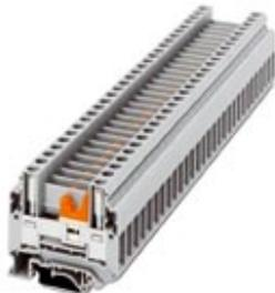
Borne interrumpible, tipo de conexión: Conexión por tornillo, sección: 0,5 mm<sup>2</sup> - 16 mm<sup>2</sup>, AWG: 20 - 8, anchura: 10,2 mm, clase de montaje: NS 35/7,5, NS 35/15, NS 32, color: gris
