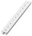
Tira Zack, Tiras, blanco, rotulado, rotulable con: CMS-P1-PLOTTER, Rotulación transversal: números correlativos de 1 ...10, 11 ...20 etc. hasta 991 ...1000, clase de montaje: encajar en ranura para índice alta, para ancho de borne: 10,2 mm, superficie útil: 10,15 x 10,5 mm, Número de índices individuales: 10
