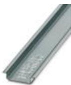
Carril simétrico sin perforar, Perfil estándar, anchura: 35 mm, altura: 7,5 mm, según EN 60715, material: Aluminio, sin recubrimiento, longitud: 2000 mm, color: plateado
